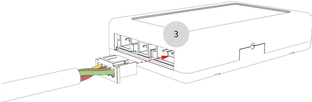
2. 將窗簾馬達的電源輸出線 ( 2Pin ) 或使用變壓器接上①號端子。
